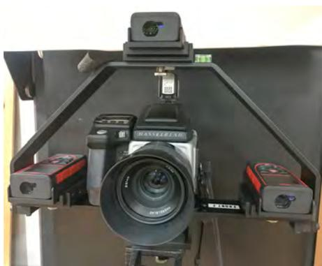
写真 26 レーザー距離計装着カメラ
