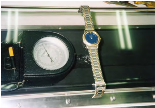
写真5 圧力計でのケース内圧の調整
