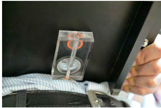
写真4 過圧防止用逆止弁
