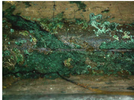
図 23 顕微鏡画像 (筒金具合わせ目: 図 17-2)
