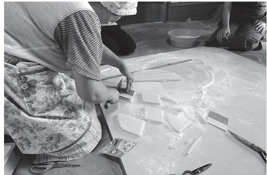
写真12 型紙を用いてひし形に成形
